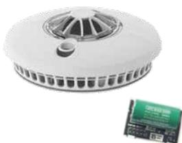
Der **FireAngel Hitzemelder HT-630-EU** überwacht mit seiner Thermistek-Technologie permanent die Temperaturveränderungen. Der Thermodifferential Melder der Klasse A1 hat eine Ansprechtemperatur von 56° C bis 64° C. Mit seiner W2-Funkschnittstelle lässt er sich in Funknetzwerke einbinden. Der Melder ist besonders geeignet für Räume mit kritischen Umgebungsbedingungen, da er resistent gegen Staub, Dämpfe, und Schmutz ist.
