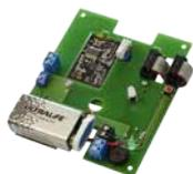
Das **W2-Relaismodul mit integriertem W2-Funkmodul** bietet die Möglichkeit externe Geräte anzusteuern und Alarmmeldungen aus dem W2-Netzwerk weiterzuleiten. Es kann sowohl als Eingangsmodul als auch als Ausgangsmodul verwendet werden.
