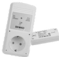
Der **Funk-Abluft-Sicherheitsschalter inkl. Funk-Magnetkontakt** verhindert die Entstehung eines Unterdrucks, durch den giftige Gase aus einer Feuerstelle zurück in den Wohnraum gesaugt werden können. Die Signalübertragung des Sicherheitsschalters erfolgt über eine gesicherte Funkübertragung, die nicht durch andere Sender beeinflusst bzw. gestört wird.
