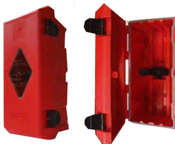
Sehr stabiler und witterungsbeständiger roter Kunststoff (LKW-Version, auch im Innenbereich einsetzbar), plombierbar, inkl. eines zentralen, stabilen Klemmring mit PVC-Halteband für den Feuerlöscher (geeignet für DRM 150 - 170 mm) temperaturbeständig (- 40°C bis + 80°C)
